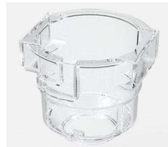
Le cône de positionnement permet de traiter jusqu'à 8 ou 10 secteurs grâce aux 6 transducteurs de la sonde de thérapie. Pour ce faire, il permet à la sonde d'être pivotée par l'utilisateur après le traitement des 6 premiers secteurs, et de traiter les secteurs supplémentaires permise par la seconde position ainsi obtenue.
